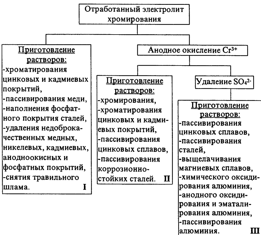
Рис. 7.1. Схема возможных путей вторичного использования (рекуперации) отработанного электролита хромирования
