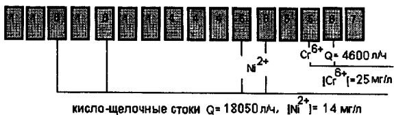
Рис.3.2.Гальваническая линия нанесения декоративного покрытия (никель-хром) производительностью по никелированию 25 м²/ч, по хромированию 3 м²/ч: 1- электрохимическое обезжиривание, 2-каскадная промывка, 3- активация, 4- никелирование, 5- улавливание, 6- хромирование, 7- сушка, 8-холодная промывка.
