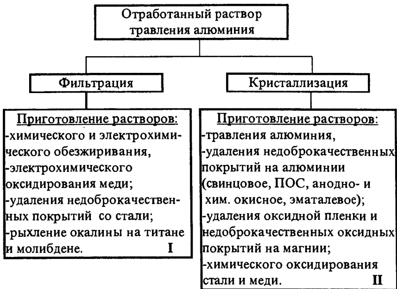
Рис.7.6. Схема возможного пути вторичного использования (рекуперации) отработанного раствора химического травления алюминия и его сплавов.
